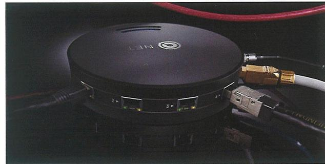
屏蔽外來各種射頻干擾，同時能為機內的線路提供良好的散熱效能，也有助降低諧振。QNET是一個主動式網絡交換器，採用LEMO接頭，備外置9V電子變壓器，當然，要盡善盡美，其實還可以考慮加入Nordost的QSource線性LEMO接頭電源供應器擷取優質電源，不過，QSource是後話，今次測試，我只用跟機火牛。
