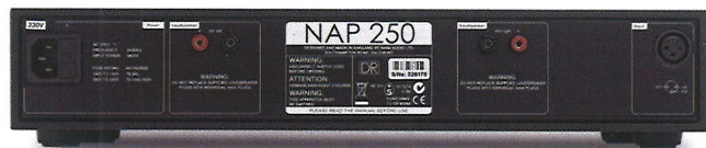
▲ NAP 250 DR立体声后级比较特别，采用一条XLR信号线即可传输两个声道的信号
