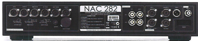
▲ NAC 282前级采用的是Naim独有的DIN接口，并且需配合同门的后级或配备NAPSC 2供电单元才能使用
