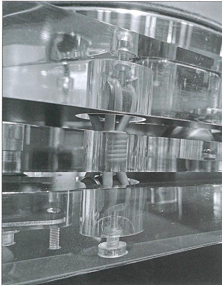
從 RG-1 的透明的亞加力底盤，可以清楚看到懸掛系統所用的橡筋。
