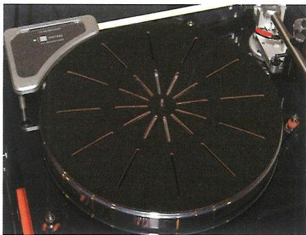
△這塊 Vertere 製造的 Techno Mat 唱片墊，用特製纖維製成，底層是水松 / 聚合物的合成物料，為唱片提供氣墊式的承托，非常有效。
