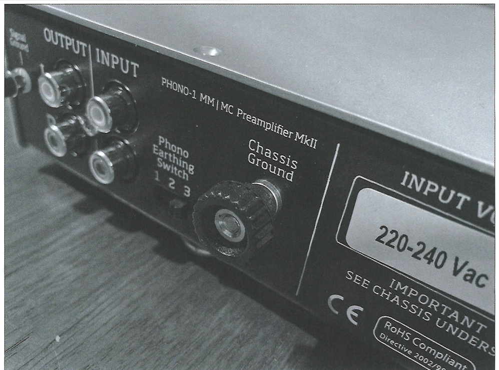
機背一大一小兩組分別給唱頭 (Signal Ground) 和 機殼 (Chassis Ground) 落地的接線柱。
