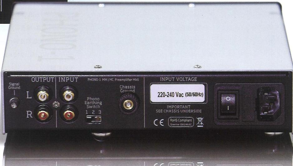
接地端子方面，除了讯号端器材接大地柱之外，还有用来连接唱臂接地线的机箱接地连接端子，此外，唱头接地的方式还通过一个拨杆开关提供三种方式可选，分别是“Hard Ground”（硬接地）、“Ground Lift”（悬浮接地）和“Soft Ground”（软接地）。众所周知，黑胶转盘系统最扰人的就是有背景哼声，这大多是因为接地不良造成的。通过切换和比较这三种接地方式，可以将Phono-1 MKII MC/MM唱头放大器可能产生的哼声降低到尽可能低的程度。
