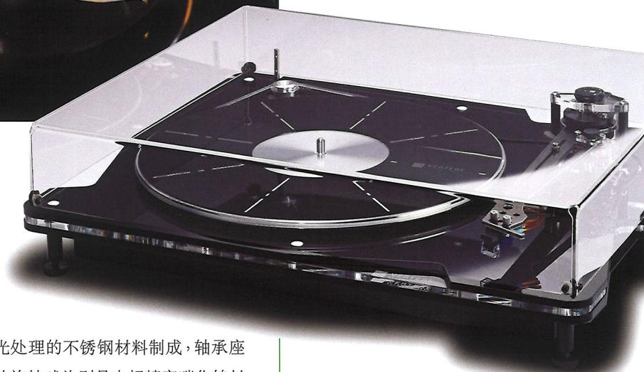
比较轻盈，也较同系列的另3款唱盘的承片盘薄一些。这只承片盘由铝合金材料经过精密机械加工而成，顶面粘合了PETG共聚聚酯制成的唱片垫，而在承片盘底部，更是粘合了一层由软木、氯丁橡胶、丁腈橡胶组合而成的特殊表面，以有效地抑制承片盘谐振。承片盘的驱动轮也是由铝合金精密机械加工而成，通过特别定制的硅胶传动皮带实现平稳而耐久的转动。33.3/45rpm的转速切换是通过电子方式由后方一只开关完成，不需要对传动皮带进行任何操作。承片盘的主轴承由经过高度
