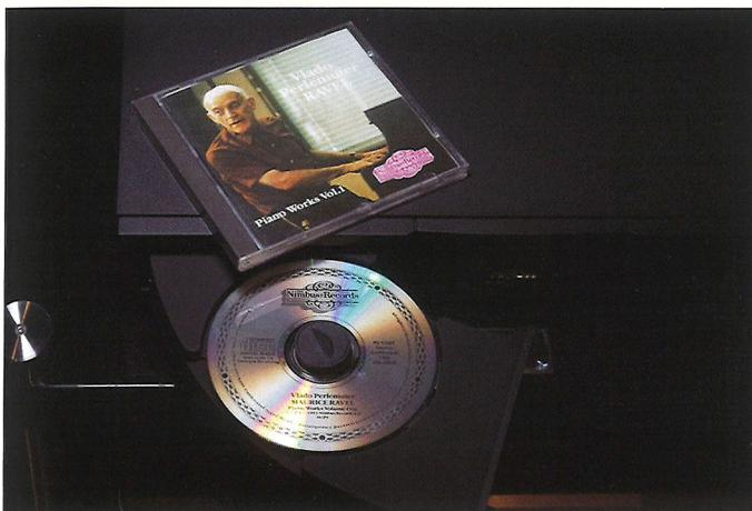
CD5Si的CD光驱纯手动操作的，而且是整个机芯安装在托盘里
