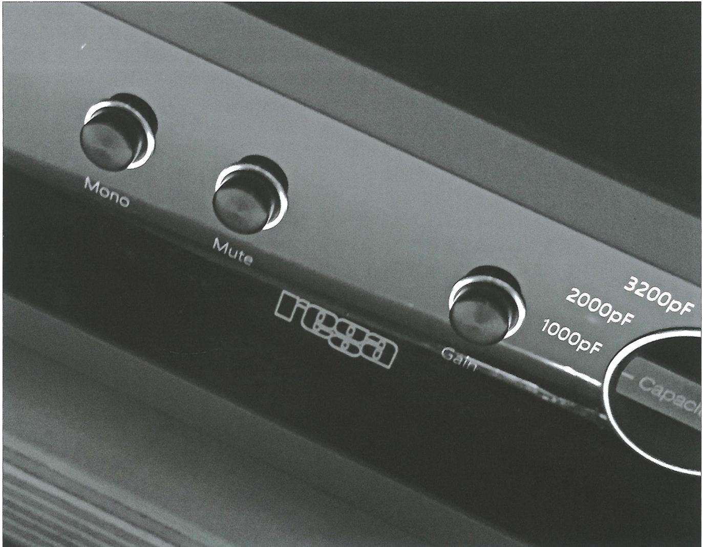
Aura 所設有的多級阻抗和電容 pf 選擇，還有 High/Low Gain 都可透過面板上的旋鈕去控制。
