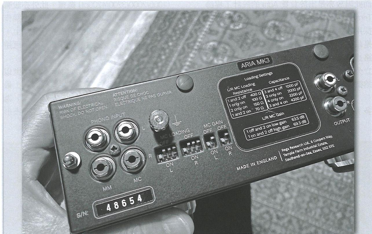
Aria III 在功能上跟 Aura 一樣，都設有多級阻抗、電容值和 HighLow Gain 選擇，不過操作上就並非如 Aura 般以旋扭式設在面板上，而是透過機背上的多組打擊，
