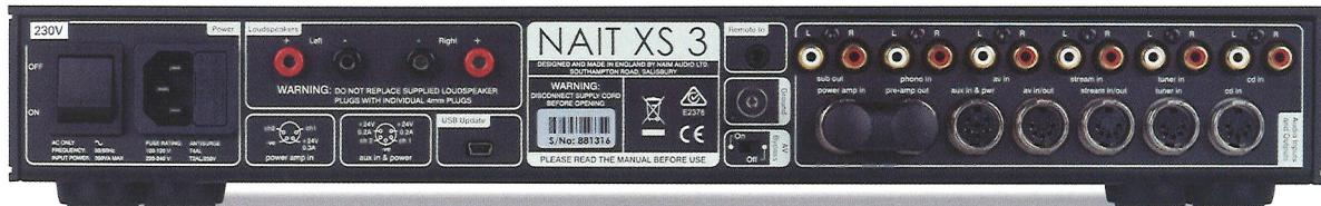
輸入介面夠多，而且實用。NAIT XS 3分別有四組立體聲RCA輸入、一組為MM唱頭而設的Phono輸入；五組DIN插頭，其中一組對應同廠Stageline唱頭放大器，亦有一組可用於連接Hi-Cap DR供電器，兩組並任輸入與輸出。它設有一組立體聲RCA輸出，方便用家連上超低音。另有兩組DIN，分別用作前級輸出與直接連接後級的輸入介面。廠方更沒有忘記家庭影院用家，所以在NAIT XS 3身上可以找到AV Bypass功能。
