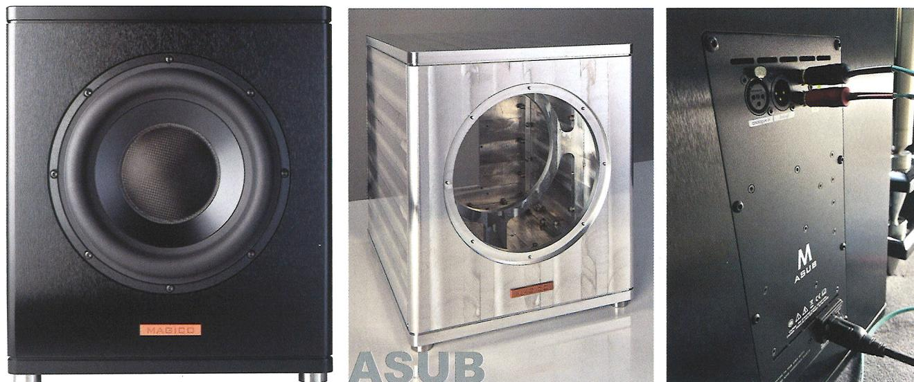
ASUB採用一個10吋口徑Magico出品特剛、特硬（硬度與重量比）鋁音盆，音盆後用上55mm口徑鈦音圈與超大磁體，以超穩定磁場及控制力進行準確的長衝程運動。規格上，ASUB可以超低失真的110dB音壓重播50Hz頻率。ASUB箱內除了內置500W功放，還加入數碼控制主動式分頻與DSP管理線路。廠方強調，其DSP能讓ASUB與Magico的主聲道完美交接，另外，還提供三組記憶預設讓用家聆聽最佳的電影音效、兩聲道及多聲道音樂！
