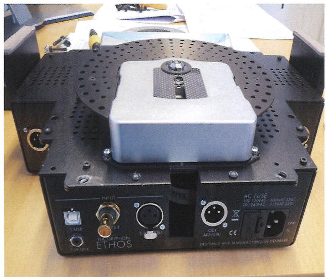
△ Stream Unlimited CD - Pro 8 鑄鋁外殼雷射機芯。
