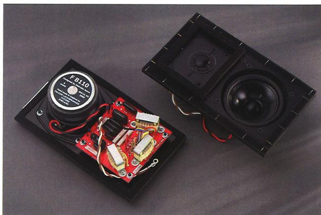
**规格参数** ■ 设计：2路密封式扬声器 ■ 频率响应：70 Hz–20 kHz (±3 dB) ■ 输入灵敏度：83 dB (2.83V @ 1m) ■ 平均阻抗：15 Ω ■ 中低音单元：138mm Falcon Acoustics B110，通过评级及配对 ■ 高音单元：19mm Falcon Acoustics T27，通过评级及配对 ■ 分频器：BBC 研发 Falcon Acoustics FL6/23，所有零件经过测量及配对 ■ 分频点：3 kHz ■ 音箱：精选多层桦木夹板，面板采用桦木支架进行固定，内部设有阻尼物料 ■ 外饰：胡桃木 Walnut、玫瑰木 Rosewood、胡桃树根 Burr Walnut ■ 体积：305 x 190 x 165 mm ■ 重量：5.35 kg
