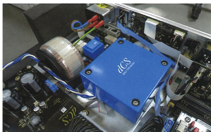
Bartók 的内部 Ring DAC 就占了很大的空间，那是 dCS 的看家本领，也是目前最好的分立式 R2R 多 bit 解码之一，整个箱体塞得满满的，看起来很值。Bartók 同时推出两个版本，除了基本解码型号还有耳放版本，加装一套输出功率 1.4 Wrms (33Ω 负载) / 0.15 Wrms (300Ω 负载) 的高保真耳放线路。标准版只有一只蓝色变压器 (Rossini 使用双变压器)，环形变压器是耳放版本才有
