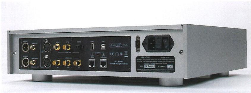
Bartók 的输入界面应有尽有，当中包括 USB 2.0 A 型随插即用，B 型 Class 2 异步等。当使用 USB 及 Dual AES 双线模式时，可接收最高 DXD (24 Bit / 384 kHz) 及 DSD128 讯号 (DoP 封包)，同时支援 dCS 加密 DSD 数字传输，Bartók 还能以 BNC 线接外部时钟，原厂建议使用 Rossini 数字时钟
