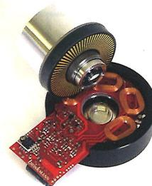
动马达，独特的“软性”速度控制和罕见的承片盘设计同样得以保留，不过，这三款产品的相似之处也就到此为止了。作为创新性的设计，Taurus黑胶唱盘采用了一只设计灵感来自于Balance唱盘的40mm厚杜拉铝合金材料大型承片盘，重达10kg，采用嵌入式安装，由磁场马达直接驱动，流体动力滑动轴承工作安静并且免维护。同时，承片盘表面铺有平面抛光水晶玻璃垫，便于清洁并提升性能。采用这种大型承片盘使得Taurus黑胶唱盘具备有更为深入、更具穿透力的低音表现，同时还结合了敏捷的动态和有效的推动力，这也是所有Brinkmann Audio品牌直接驱动唱盘
