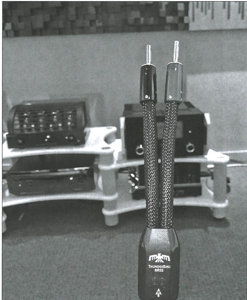
支只接到喇叭柱的一端，擴音機的一端沒有接著，這是「地迴路噪音排放技術」，能有效形成一個模擬電場保護層，有效把再微細的靜電雜訊，都一併帶走。如此一來，如果是 1+1 組合 (Zero+Bass)，有最佳的防護外界雜訊影響之同時，又能提供極潔淨的音色，完全能發揮擴音機和揚聲器的效果。
