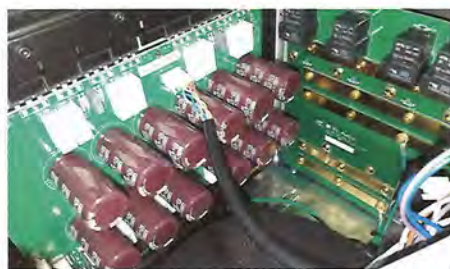
看看DirectStream Power Plant P20的功放部分，每一个功放线路一共使用了16只功率管，滤波电容一共采用12只4700 \mu F容量的电解电容，从而达到大功率输出的目的
