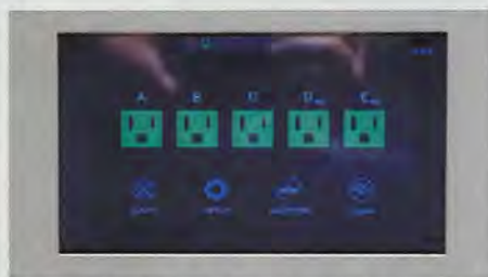
这里可以控制各个电源插座的电源通断，Power Plant P20提供了5组插座。其中，D和E组为高电流输出，给予后级使用
