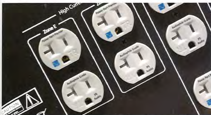
DirectStream Power Plant P20提供7组(共14个)输出插座,其中有2组是高电流输出,用来连接大功率后级
