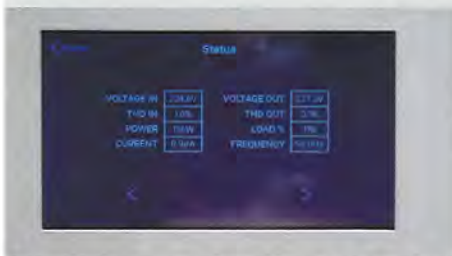
Status界面为状态监控界面，用于监控电源状态，包括输入/输出电压值、电源的输入/输出失真度、负载总量、电流值以及电源频率
