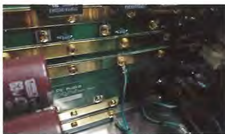
功率放大器至电源插座端之间采用铜母线连接，可以容纳大电流传输，对于驱动大功率功放时有显著的优势，在重播大动态音乐时声音就不会有被限制的感觉
