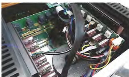
打开DirectStream Power Plant P20之后就可以发现，其内部实际上就是一台功放，功率放大线路分别安装在机箱的左右两侧
