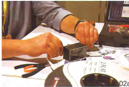
02a/b: 首先将线材通过特殊的开线器，将2 FLAT扁平线一分为二
