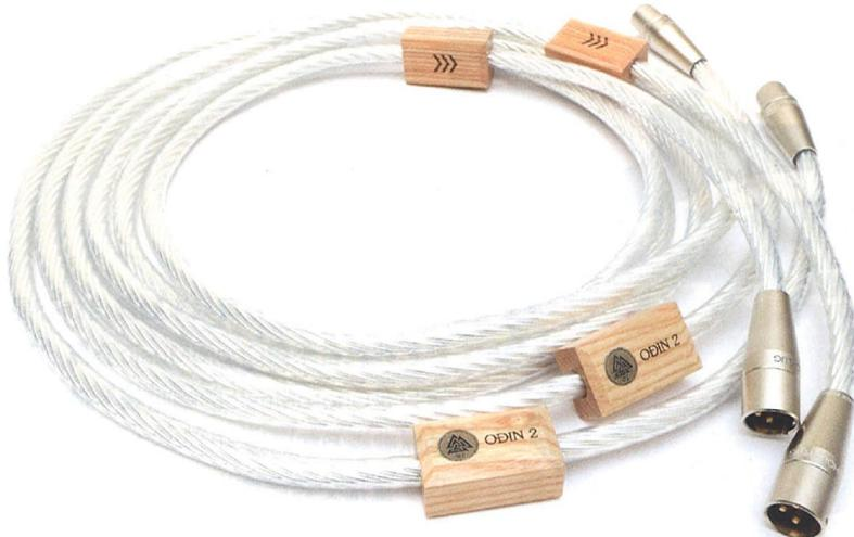
**O**din 2訊號線內有10條獨立絕緣線芯，導體是23 AWG粗度的99.999999% 純度單枝實心OFC銅，外層鍍銀。電介質是以Dual Mono-Filament技術編織出來的高純度FEP，外邊再套以FEP層。配合Dual Mono-Filament，還有一種TSC (Total Signal Control) 技術，是線內各導體平衡分隔的螺旋形狀，把線彎曲亦不會改變其結構。廠方稱這設計能讓訊號以超乎想像的高速傳送。
