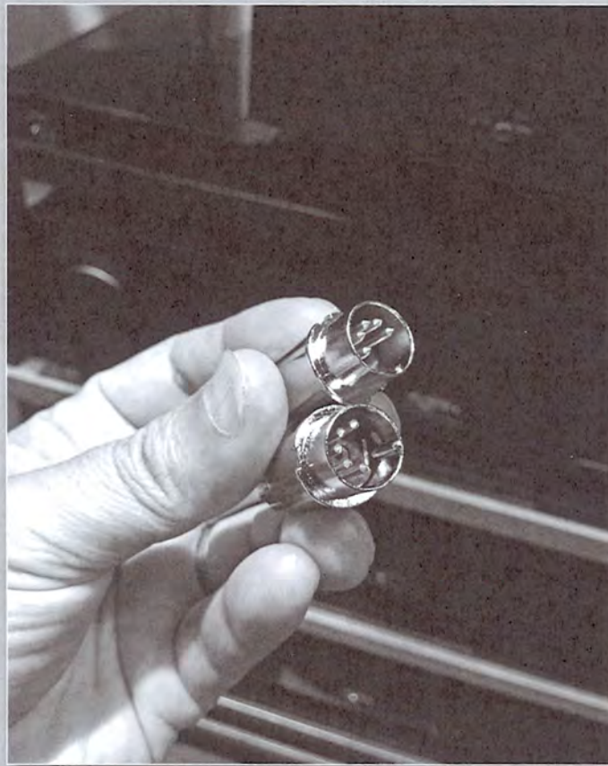
NAIM SuperLine 也是採用這種常見於歐洲 Hi-End 的活動插式電阻去調校唱頭阻抗。
