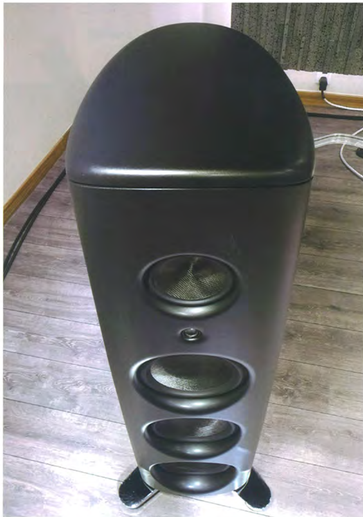
M6 音箱的上盖和前障板均由整块铝经过加工而成，前障板更需要经过两次的 CNC 才能加工成我们见到的复杂曲面形状
