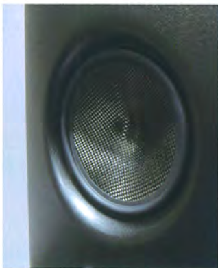
全新开发的 6 吋中音单元的振膜，使用最新科技的纳米石墨烯 Graphene 结合多层碳纤维制成，比前作碳纤维材料轻了 30%，但刚度增加 300%，从而大大减低振膜的失真度
