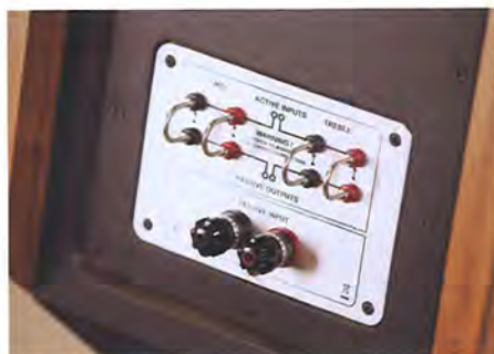
常规状态下，两箱体以接线并联，原厂提供英国 Chord 和弦高素质发烧线
