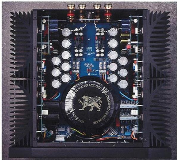
輸入端以全平衡雙差動設計，配合高速運作電壓放大級和超低噪音穩壓設施，締造遼闊頻率響應。源自同門上級型號的DC Servo直流伺服耦合技術，有效將音染減至最低。可作兩段不同偏壓數值切換的強放環節，合共使用20枚預先經過嚴格挑選和匹配，日本Sanken生產的大電流雙極強放管，每聲道提供50W（8Ω負載），100W（4Ω負載）及190W（2Ω負載）持續輸出功率。
