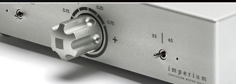
**Imperium Motor Drive 主權馬達驅動系統**，屬於 Vertere Acoustics 專為二號主帥 SG-1 Super Groove 超凡黑膠唱盤而設的高精度控速裝置，經過銀色陽極處理，不見一枚固定螺絲的機身，由原件鋁磚挖空製成，面板設有電源開關、5 段式轉速選擇及 33/45 rpm 轉速切換，機背設有 6 針 DIN 輸出插座，至於獨立電壓輸出幅度 (Level) 及相位微調旋鈕 (Phase)，則被安排在機底。隨機而來的接駁線材包括廠方特別炮製 Imperium 專用過機線及 Redline 火紅電源線。
