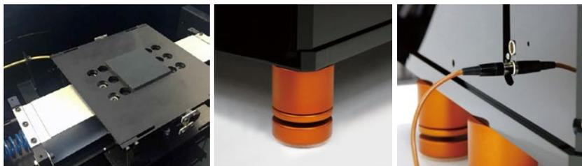
外殼分別由不同厚度亞加力所構成，配備防塵保護罩及 LED 輔助照明系統的 STAGE-1 參考承放平台，主要透過無阻尼方式將垂直運動頻率調低至近乎 0.5 Hz 水平，換言之，高於 0.5 Hz 水平的有害振動將會被消除，為器材提供一個完全不受外來滋擾的隔離地台。內部設有結構相當複雜不銹鋼 / 亞加力三文治重量補償底盤，配合能修正水平及調節頻率的秘製彈簧，確保由鋁合金和亞加力生產的三文治頂板，長期保持懸浮狀態，跟 Vertere 黑膠唱盤的內部耦合和避震結構達致完全協調的伸延，讓唱針可以安穩地進入唱片 V 坑，把所有弱音細節及微動態透過揚聲器展現眼前。
