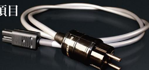
採用 3 芯設計的丹麥 貴豐 Gryphon Audio Headline 頭條 電源線，每組線芯分別由 7 條經過緊湊絞合處理，各自包含 17 股高純度無酸銅 OFC 導體所構成，並穿上抗磨損 PVC 保護外套，配以純棉填充物料作為電介質素材，有助維持機械穩定性。雙層屏蔽設計，分別以鋁 / 聚酯薄膜及金屬纖維製成，外圍則是富有彈性，提供避震功效的高密度 PVC，造就得來不易的實貴細節得以重現眼前。
