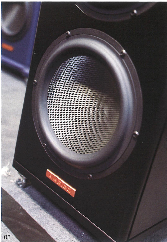
03. A5使用的9英寸低音单元，该单元振盆为石墨烯纳米技术的三文治高刚性轻质振盆 04. A5背面的接线柱
