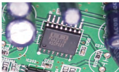
音量控制采用 BB PGA2311U 芯片作数码控制，确保最佳的可靠性与左右声道平衡度
