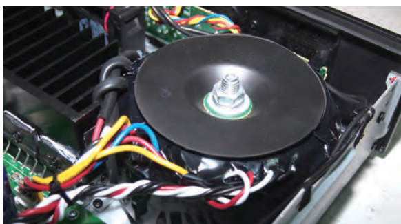
采用环形变压器供电，确保大电流输出的储备
