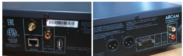
输入界面上还涵盖了时下常用的 Wi-Fi、以太网 Ethernet、S/PDIF 同轴、Toslink 光纤、USB-A 等各种类型的端子。模拟输出有 RCA 和 XLR 选择
