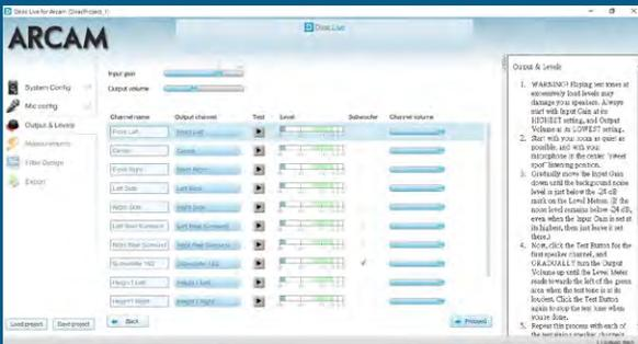
顯示每聲道的音壓，右側有詳細操作說明。
